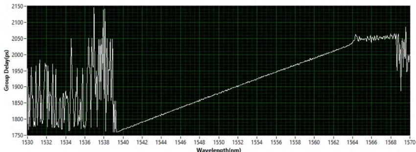
备注：测试结果分别是波分复用器 IL、波分复用器 PMD、倾斜光栅 PDL、啁啾光栅 GD。
